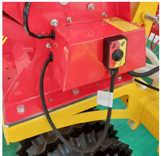
Abbildung 2: Abdrehtaster am Streuer montiert
