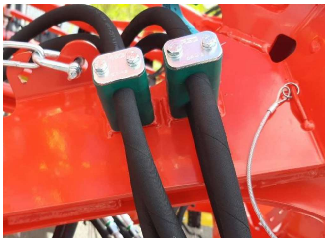
Abbildung 21: Leitungsschellen am Anbaubock
