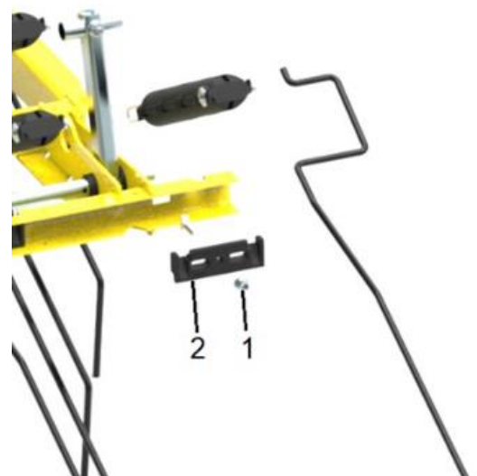
Rysunek 18: 1 = nakrętka, 2 = pakiet z tworzywa sztucznego
