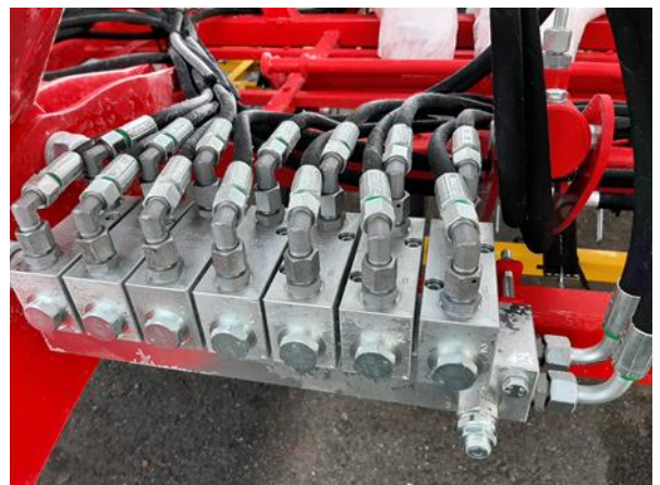
Rysunek 14: rozdzielacz na ramie środkowej
