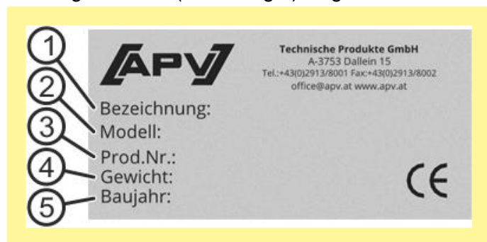
Abbildung 2: Aufbau des Typenschildes
