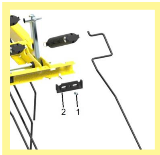
Obrázek 15: 1 = matice, 2 = plastový výlisek
