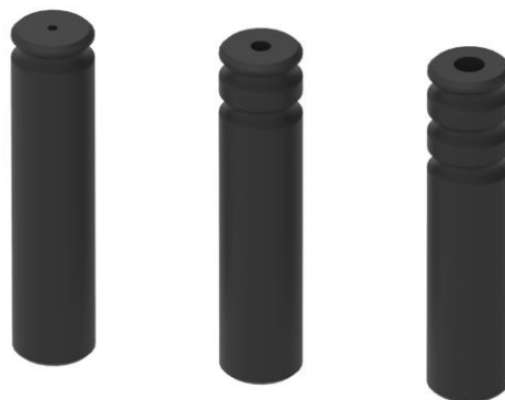
Figura 7: duză de 1 mm cu 1 canelură, duză de 2 mm cu 2 caneluri, duză de 3 mm cu 3 caneluri
